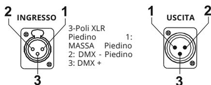
Collegare i dispositivi utilizzando un cavo bipolare schermato a 2 conduttori con connettori XLR maschio-femmina a 3 poli. La connessione dello schermo è il piedino 1, mentre il piedino 2 è negativo (S-) e il piedino 3 è positivo (S+).
